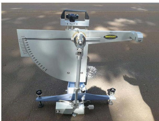
Figura 5 - Execução do ensaio de microtextura com o Pêndulo Britânico.
