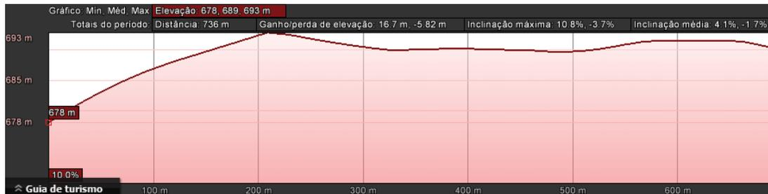
Figura 5 - Inclinação da rua Independência. Fonte: inclinação Google Earth Pro.
