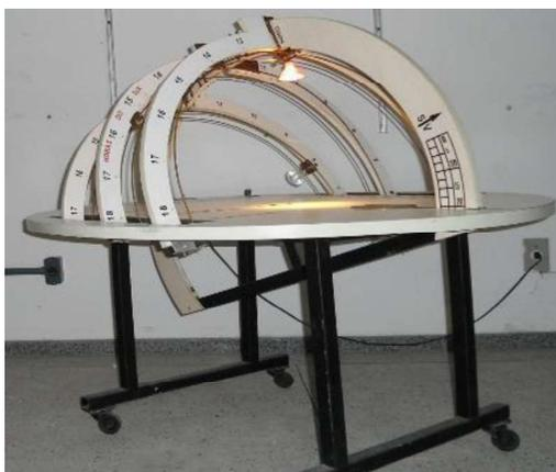
Figura 1. Heliodon utilizado nas simulações. Fonte: Acervo dos autores
