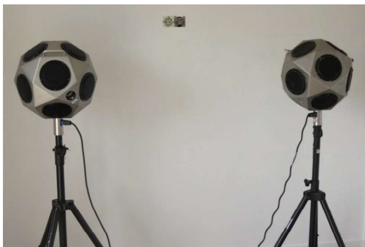
Figura 2. Exemplo da colocação das fontes num compartimento.
