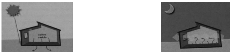
Figura 5. Comportamento do efeito da massa térmica em período de verão. Fonte: Fanou, 2007
