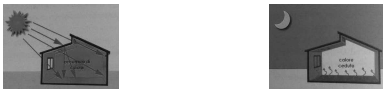
Figura 4. Efeito de acúmulo de calor em massa térmica em período de inverno. Fonte: Fanou, 2007
