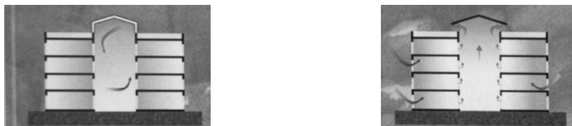
Figura 1. Átrio bioclimático com ventilação natural por efeito de diferença de temperatura (efeito “tipo chaminé”) – em inverno e verão. Fonte: Tucci, 2012
